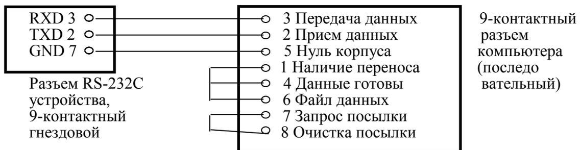
Схема соединения с выносным индикатором:
