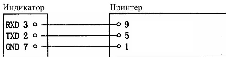
Рис. 15 Распайка для подключения принтера «CAS»
