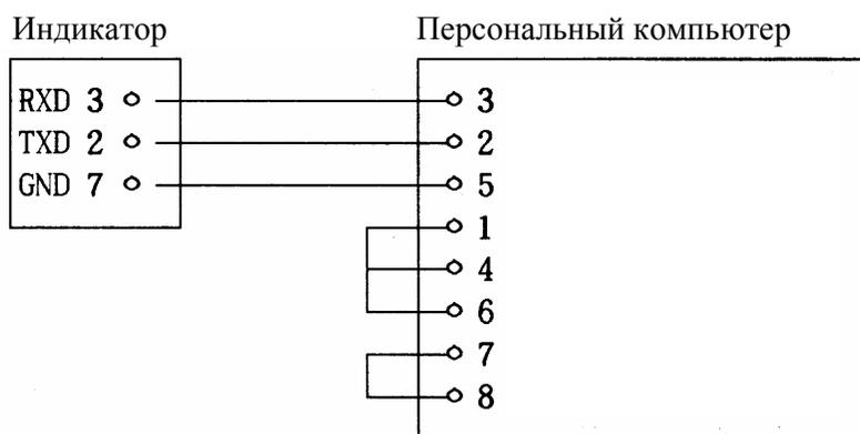
Рис. 12 Распайка для 9-ти контактного разъема
