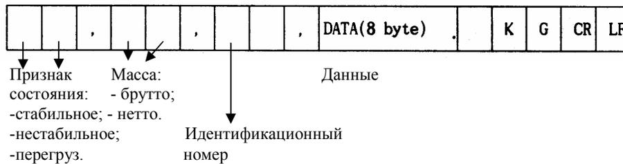
Рис. 13 Схема передачи данных
