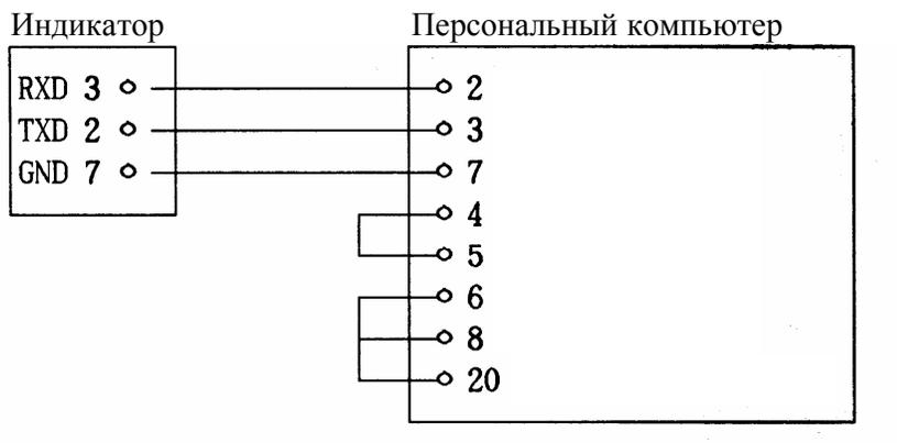
Рис. 11 Распайка для 25-ти контактного разъема
