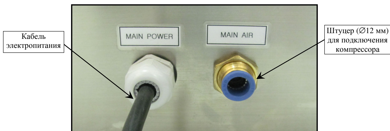
Рисунок 1.5 – Кабель электропитания и штуцер для подключения компрессора
