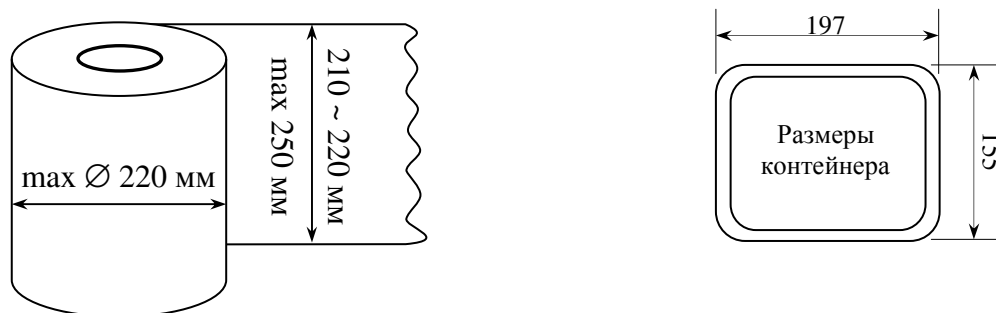
Рисунок 1.10 – Рекомендуемые и максимальные размеры рулона пленки для контейнера 155 x 197 мм
