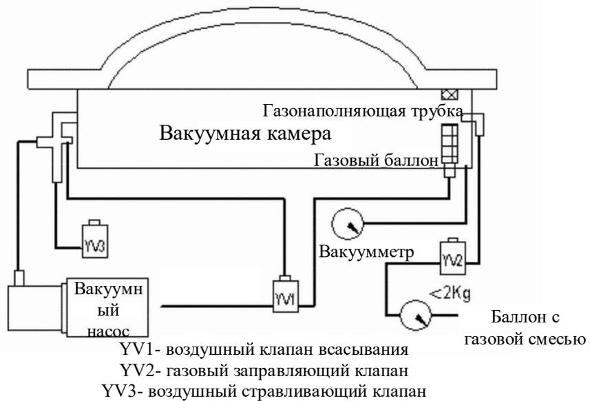
Схема вакуумного упаковщика с системой газации
