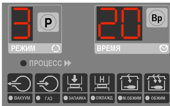
Рисунок 2.3 - Расположение таймера и индикаторов панели управления
