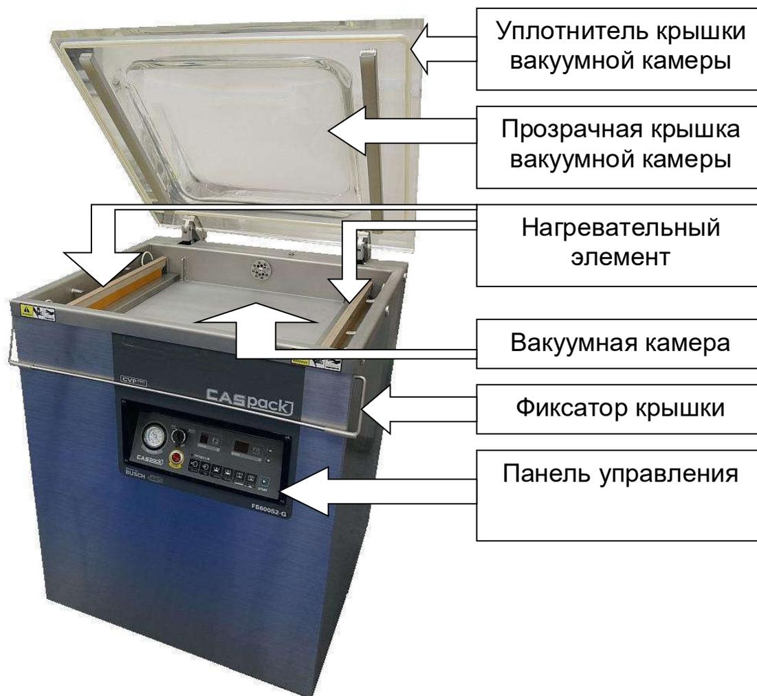
Рисунок 2.1 - Общий вид и обозначение основных элементов
