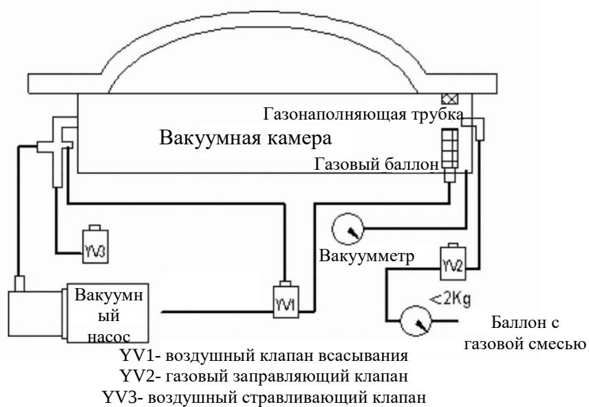
Схема вакуумного упаковщика с системой газации
