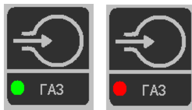
Рис. 2.4 Индикация 1 фазы и 2 фазы газации при настройке
