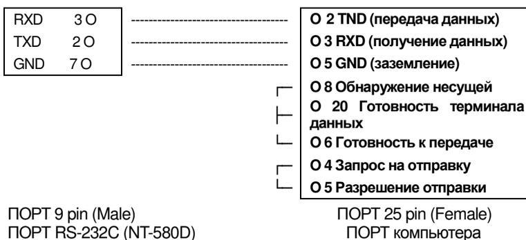
Схема подключения порта COM2 - TXD: 2, RXD: 3, GND: 7
