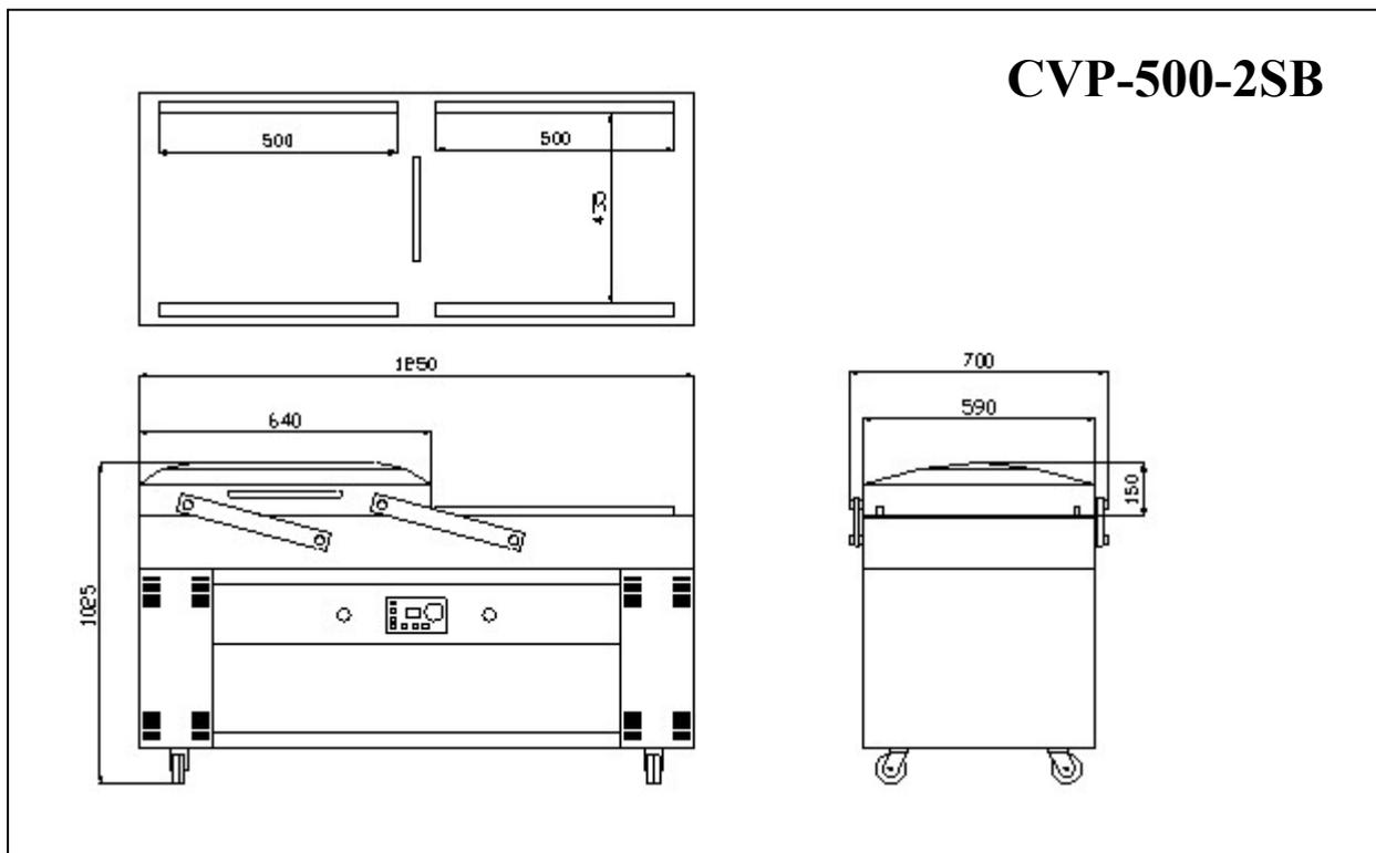
Рисунок 3.4 – Размеры вакуумного упаковщика модели CVP 500-2SB
