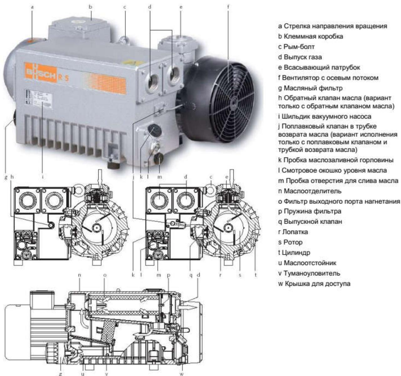
Рис. 6.3. –Составные элементы вакуумного насоса Busch RA 0063 0100
