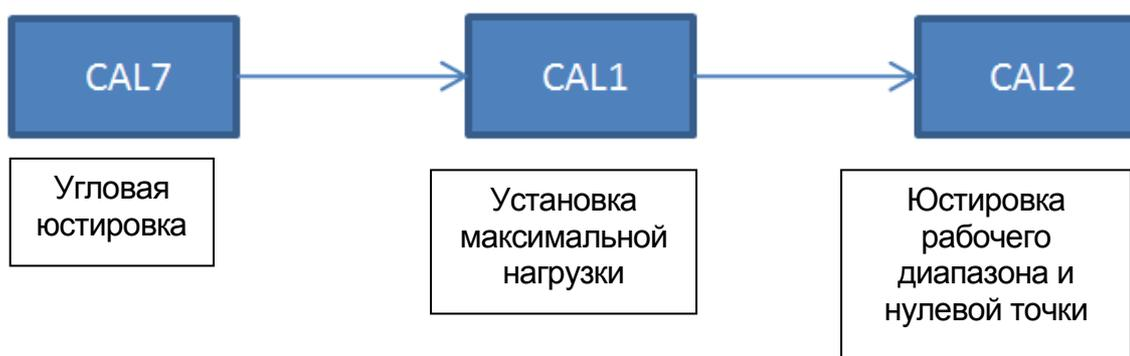
1. Для перехода в режим юстировки включите питание индикатора на задней панели, одновременно удерживая кнопку «3» на передней панели.
