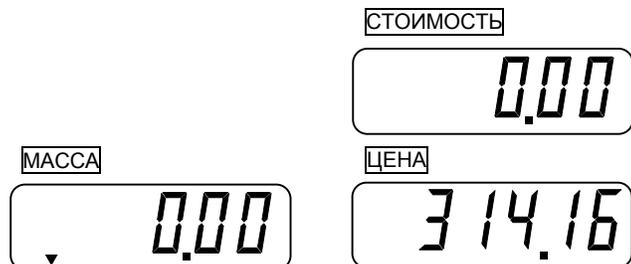
□ Положите выбранный товар на весы. Указатель «►0◀» выключится. На индикаторе **МАССА** будет показан результат измерения массы товара (здесь 0,5 кг), а на индикаторе **СТОИМОСТЬ** – его стоимость (здесь 157,08 руб) как результат произведения  $\text{СТОИМОСТЬ} = \text{МАССА} \cdot \text{ЦЕНА}$ .
