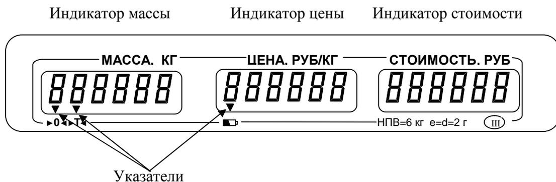
Рисунок 4.2 Вид и назначение элементов панели со стороны покупателя
