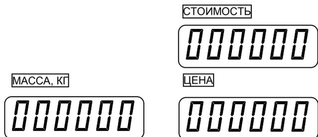
После прохождения теста весы переходят в рабочий режим взвешивания с установкой нулевых показаний на всех индикаторах. Указатель «►0◄» должен быть включен.
