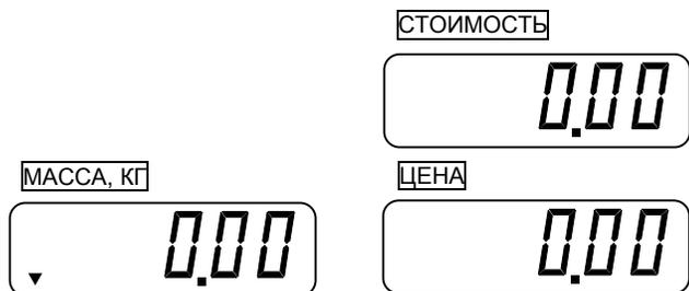
⚠ В случае дрейфа (нестабильности) показаний на индикаторе **МАССА** при пустой платформе нажмите клавишу обнуления массы ►0◄; при этом должен включиться указатель «►0◄».
