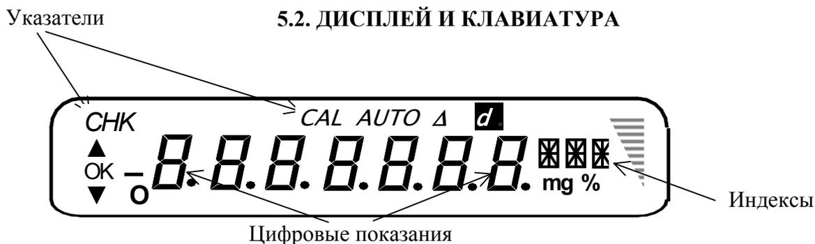
КЛАВИАТУРА выполняет функции, зависящие от того режима, в котором находятся весы:
