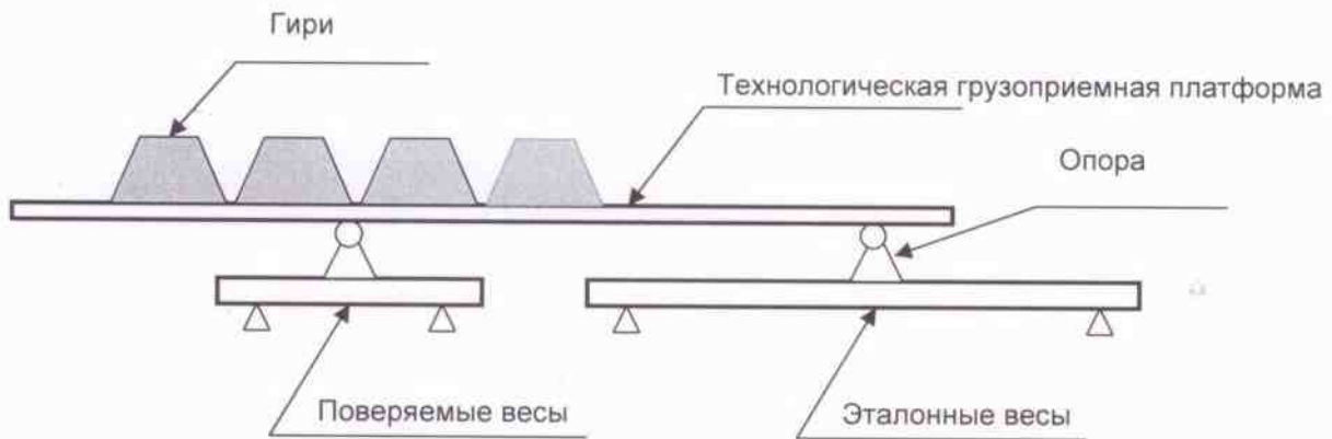
Рисунок 1 – Установка технологического оборудования при поверке одиночной платформы весов
